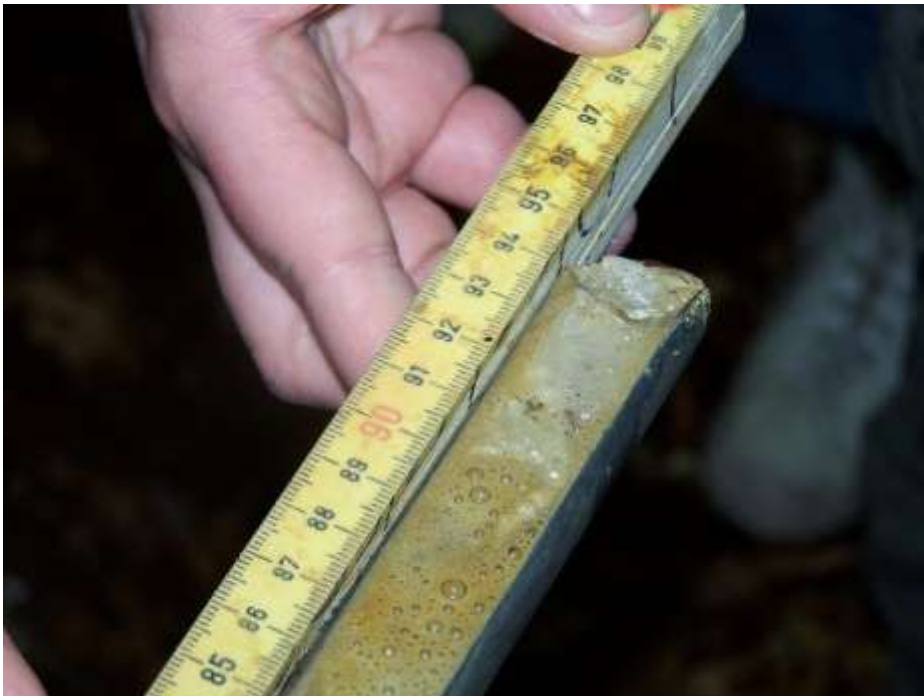
Abbildung 11: Kalknachweis im S d -Horizont des Pseudogleys mittels Salzsäure. Nach Hofmeister (1997) deutet das starke, langanhaltende Aufbrausen auf einen Kalkgehalt von über 5% hin. Die Bodenprobe wurde zuvor unter Zuhilfenahme des Pürckhauers entnommen. Datum: 02.05.2009, Foto: M. Scheunchen
