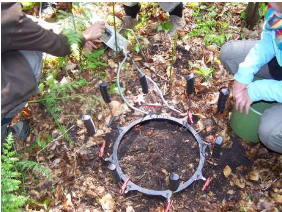
Abbildung 13: Oktettmethode nach Thielemann. Elektrische Methode zum Austreiben von Regenwürmern ( Lumbricidae ) aus dem Boden im Wolbecker Tiergarten, Münster. Zu sehen ist ein kreisrunder Metallring verbunden mit acht Elektroden (65 cm Länge und 6 mm Durchmesser) sowie ein Transformator, der gerade bedient wird. Datum: 02.05.2009; Foto: M. Scheunchen, GPS-Position: 51°54,826'N, 7°44,566'E
