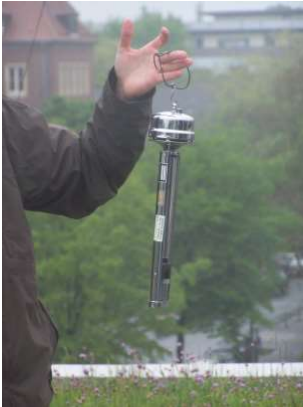
Abbildung 23: Ein Aspirationspsychrometer nach Aßmann (1892) zur Bestimmung der relativen Luftfeuchtigkeit. Damit die Messung weder von Körperwärme noch Atemluft beeinträchtigt wird, wird diese auf Körperhöhe vom Körper abgewandt durchgeführt. Die Dauer der Messung beträgt ca. 5-10 Minuten. Datum: 06.05.2009, Foto: S. Roncossek
